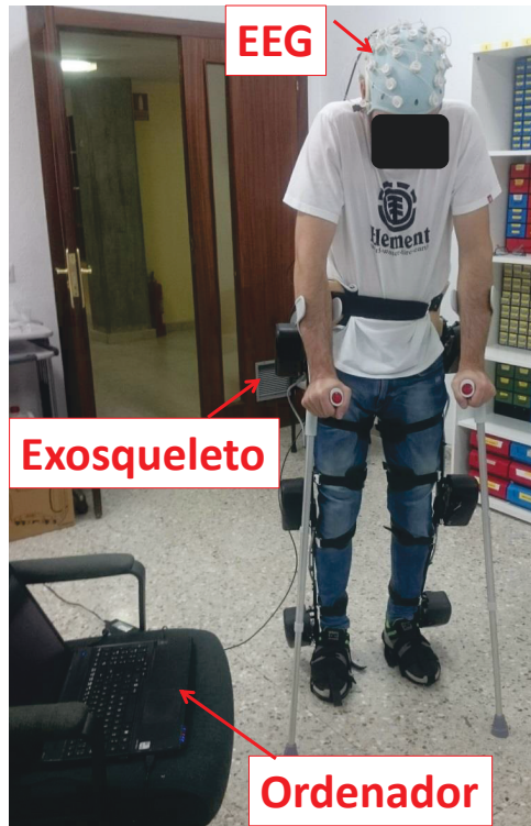
Figura 1: Montaje experimental del escenario 2 (E2). El usuario realiza las tarea de relajación e imaginación mientras se graban sus señales EEG. Durante el periodo de imaginación de la marcha, además, el exoesqueleto se mueve por si mismo.
