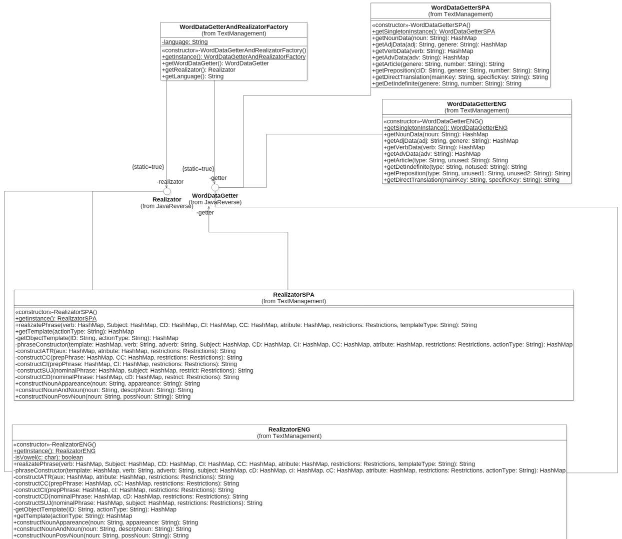
Figura 4.11: La facotría WordDataGetterAndRealizatorFactory con las interfaces WordDataGetter o y Realizator y las implementaciones de estas.
