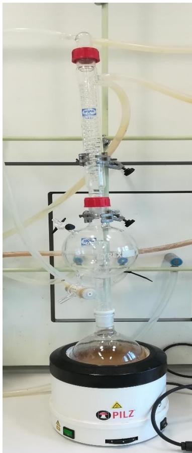
*Ilustración 2: Montaje de reflujo para el secado de disolventes*
