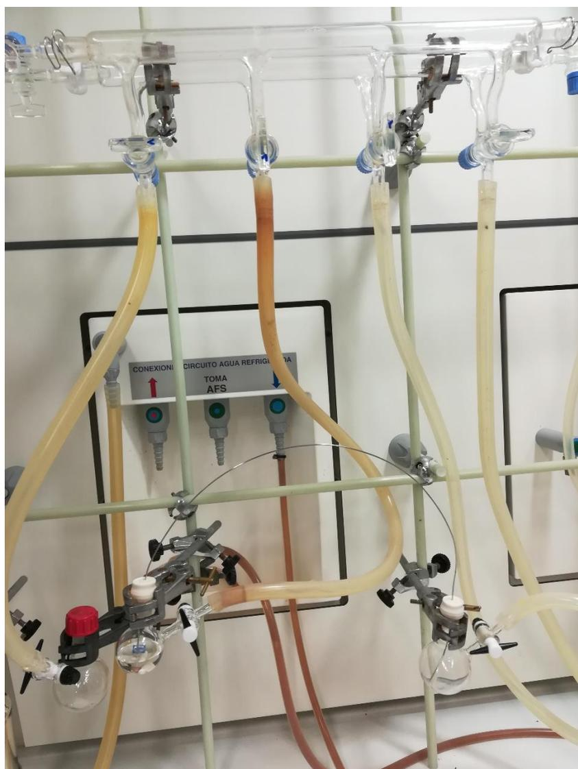
*Ilustración 3: Montaje de filtración a través de cánula*
