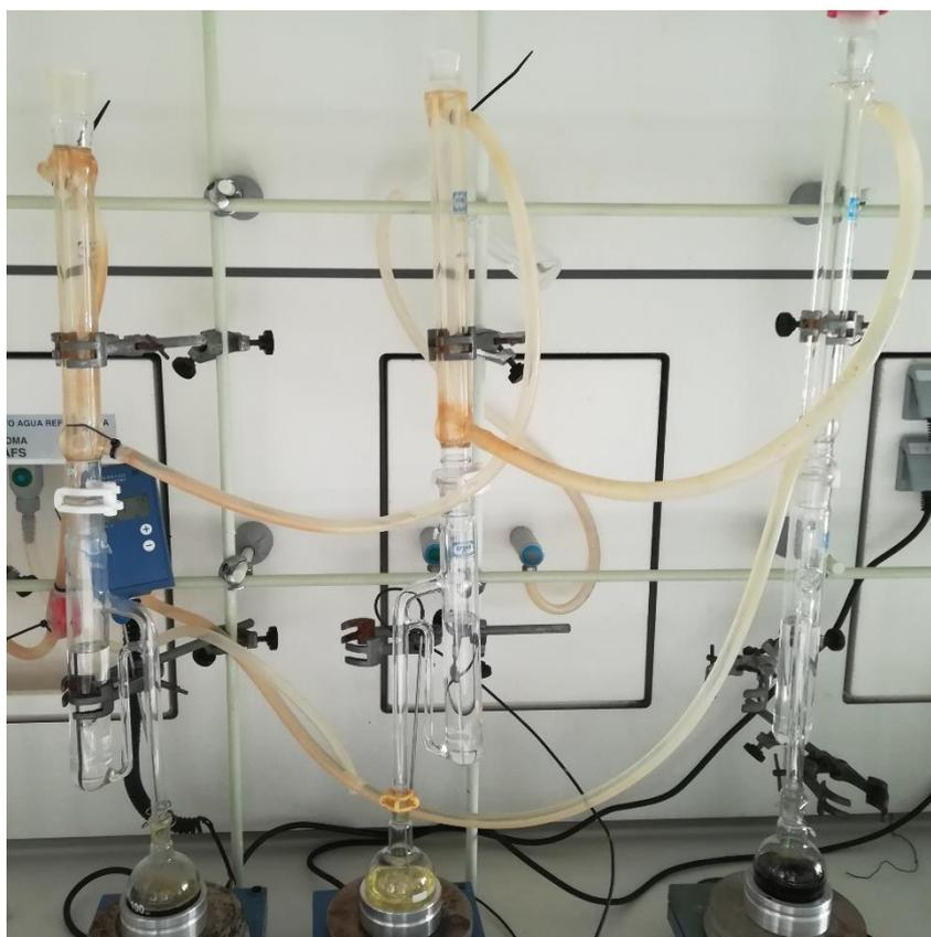
*Ilustración 1: Montaje de reflujo con Dean Stark modificado*
