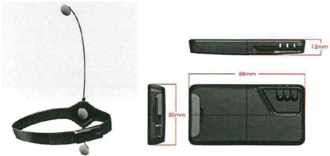
Figura 93: Versión mejorada del dispositivo eBack. Elaboración propia.
