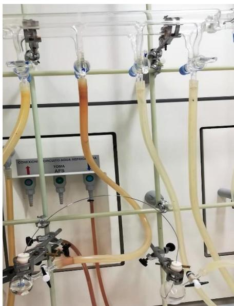
*Figura 20. Filtración con cánula bajo atmósfera inerte*
