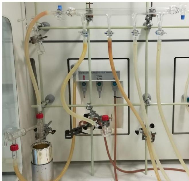
*Figura 19. Línea de vacío con trap para la preparación de los complejos de rutenio en atmósfera inerte.*
