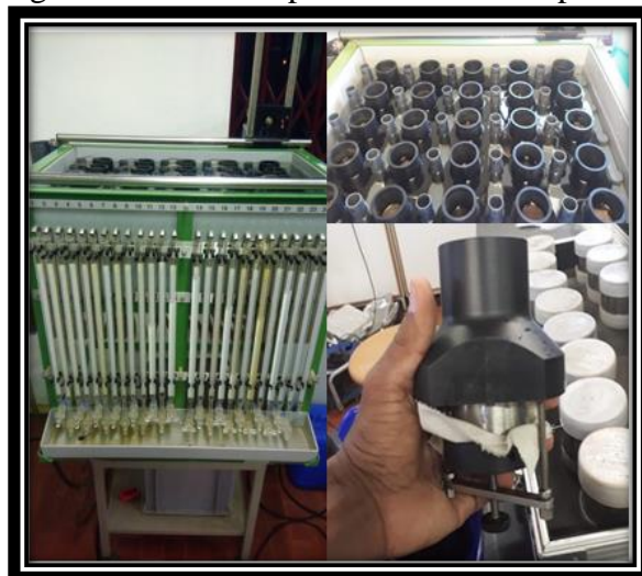
Figura 33.- Imagens do ensaio de permeabilidade no permeâmetro utilizado
