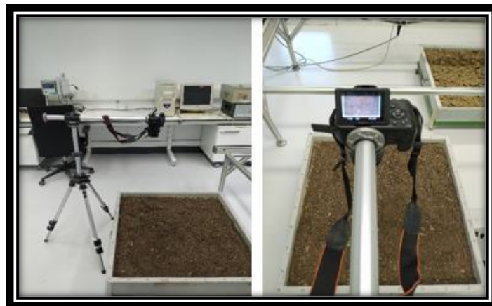
Figura 17.- Representação de uma bandeja de baixa rugosidade submetidas a captação de imagem para uso da fotogrametria.
