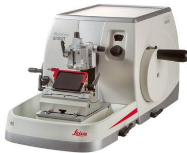
Figura 6. Fotografía de un microtomo de rotación. Fuente: https://www.leicabiosystems.com/es/equipo-histologia/microtomos/histocore-biocut/ (Última consulta 26/07/2019).
