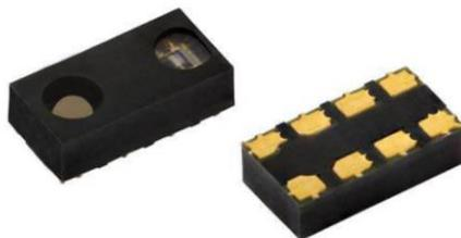
**Figura 17: Sensores Infrarrojos modelo VCNL4040**
