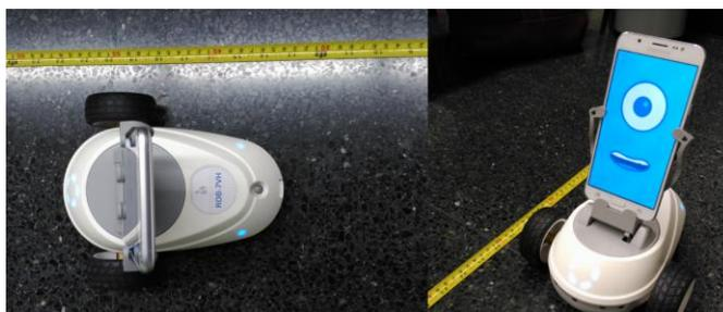
Figura 46: Medida de la distancia recorrida por el Robobo.
