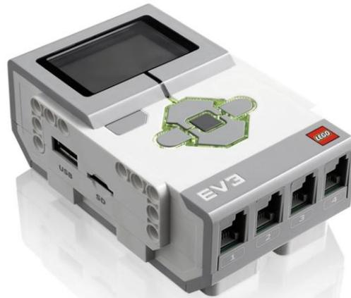
**Figura 6: Controlador EV3 de LEGO Mindstorms.**
