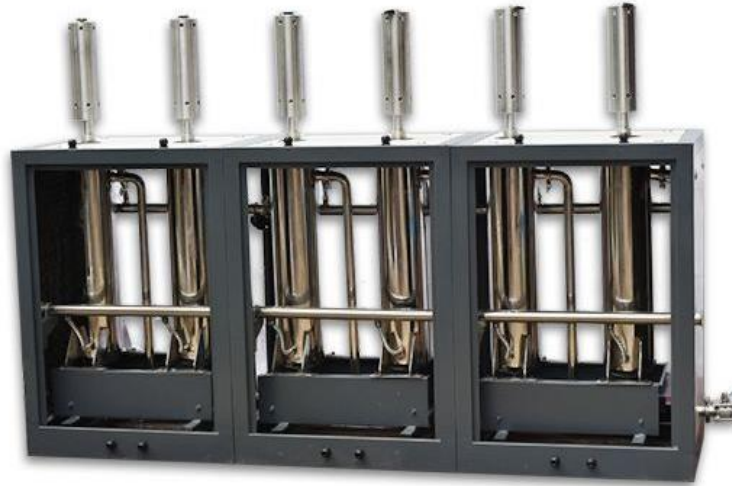
Figura 6.2.2.5.1 - Equipo de ultrasonidos para el tratamiento del agua. Fuente:
