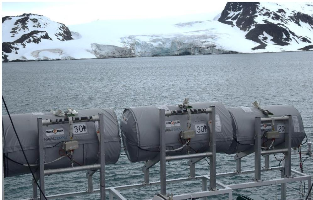
Figura 7.1.1.- Balsas salvavidas con funda térmica. Original del autor.
