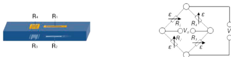
Figura 28. Configuración del puente de Wheatstone para momentos flectores.
