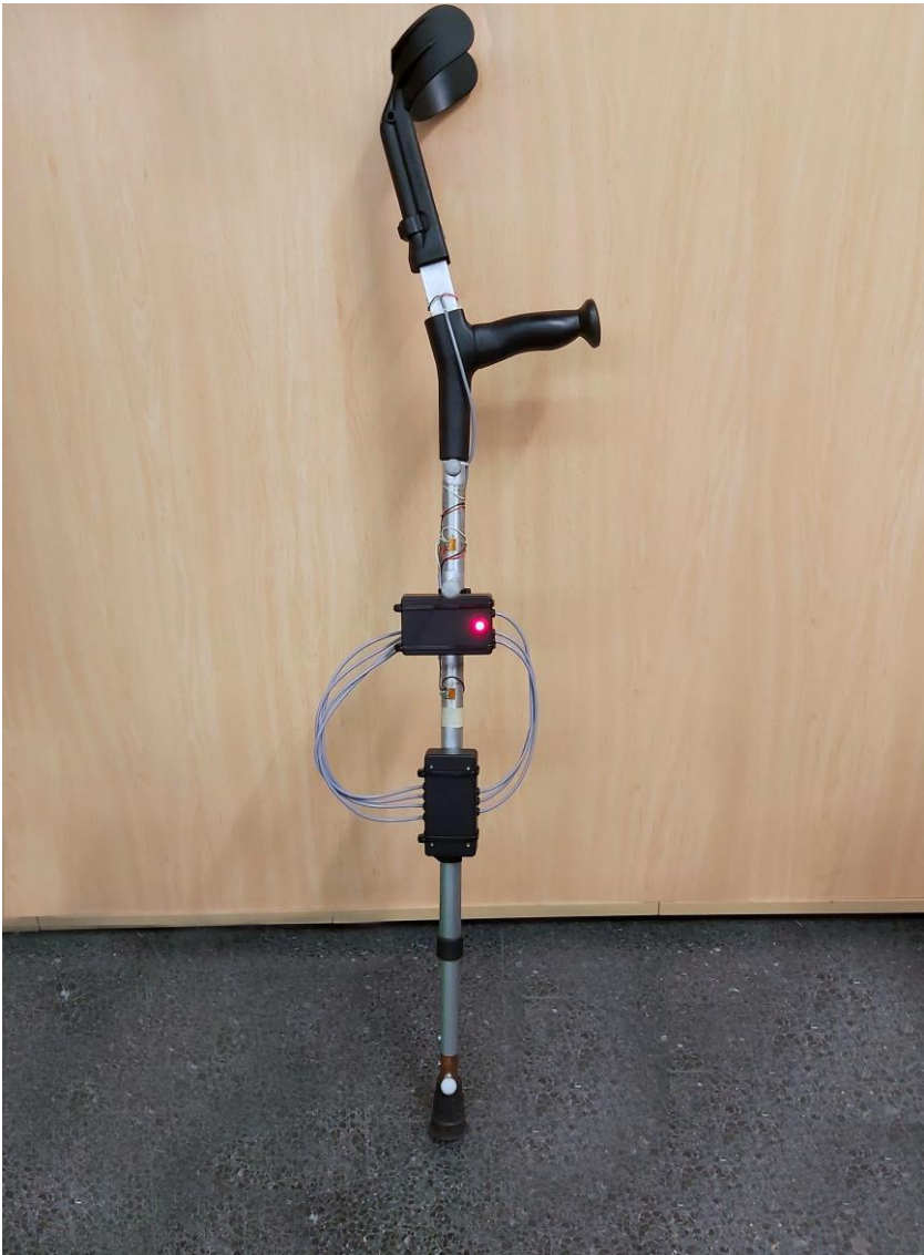
Figura 44. Montaje final de las placas en la muleta.
