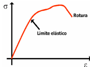
Figura 3. Relación entre esfuerzos y deformaciones.
