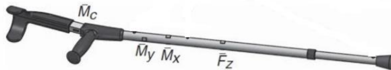
Figura 26. Muleta instrumentada con galgas extensiométrica [18].
