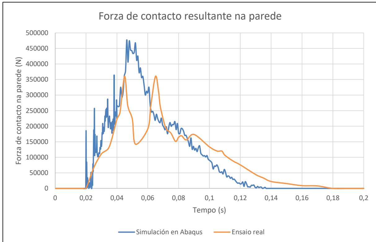
Gráfica 4. Gráfica da forza de contacto resultante na parede para o Geo Metro no ensaio real e na simulación en Abaqus.
