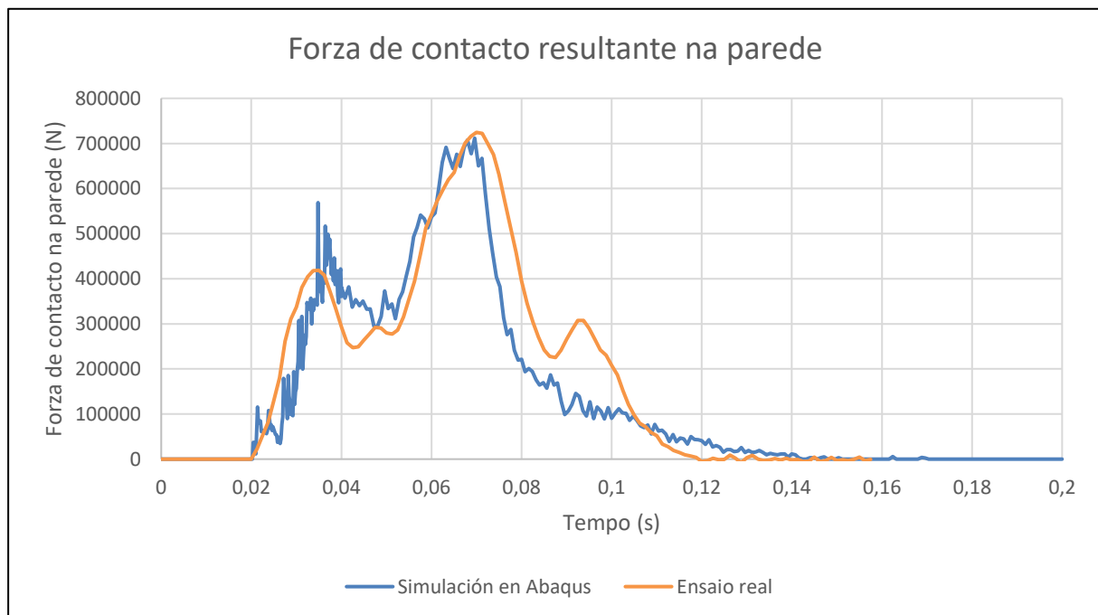
Gráfica 3. Gráfica da forza de contacto resultante na parede para o Chevrolet Silverado C1500 no ensaio real e na simulación.
