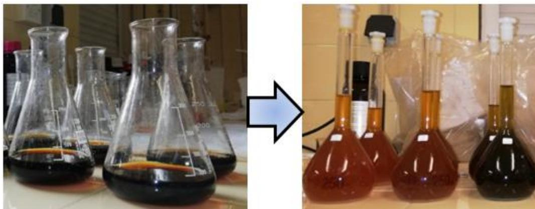
Figura 8. Erlenmeyers con suelo, ácido sulfúrico y dicromato potásico y matraces aforados con el contenido de los Erlenmeyer y enrasados con agua; respectivamente.
