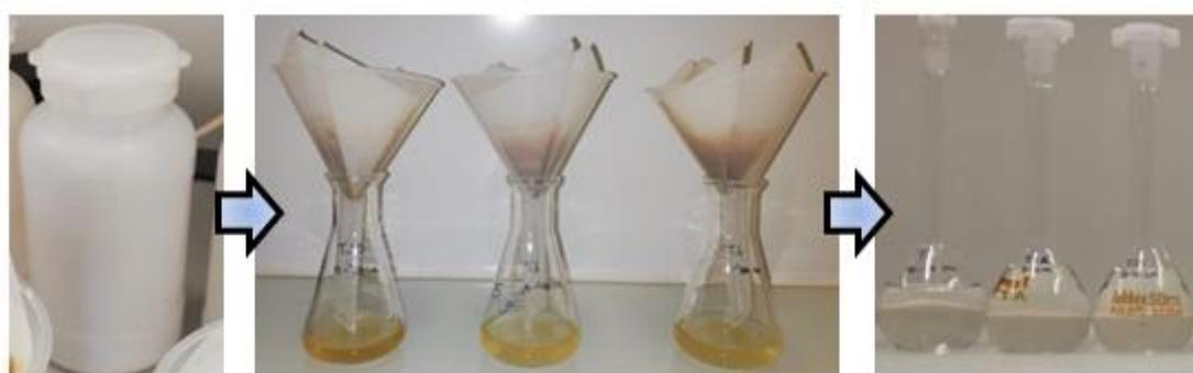
Figura 10. Bote con el suelo y la solución extractante, filtración después de la agitación y matraces aforados con las soluciones antes de aparecer el color; respectivamente.
