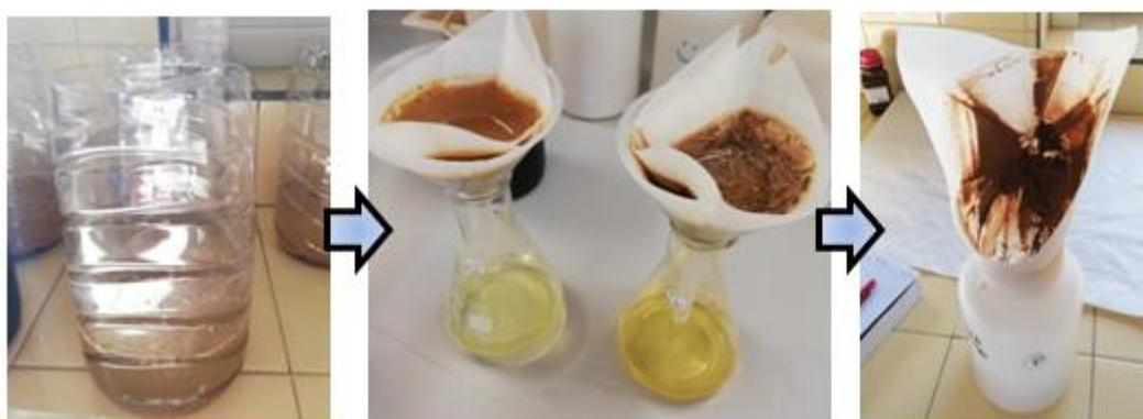
Figura 6: Suelo con  $H_2O_2$ , filtración del contenido del bote y recogida del suelo en botes de plástico para su posterior agitación; respectivamente.
