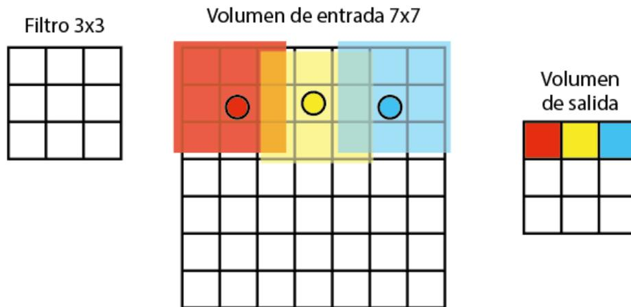
Figura 3.6: Ejemplo de aplicación de un filtro  $3 \times 3$  con stride de 2 en un volumen de entrada de  $7 \times 7$ .
