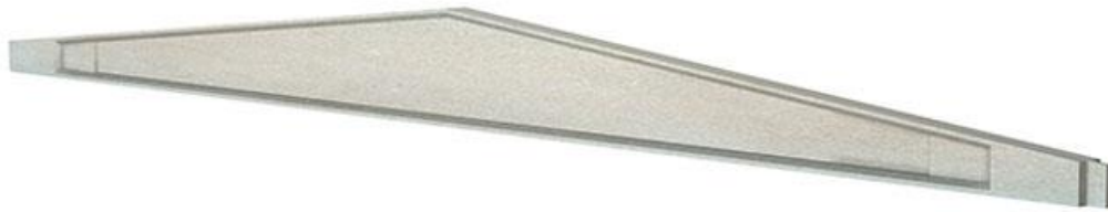
Figura 12. Modelo 3D viga prefabricada (fuente: Gilva)
