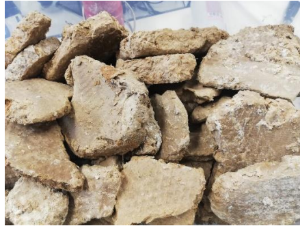
Figura 38. Lodos deshidratados con filtros prensa en la EDAR 2.
