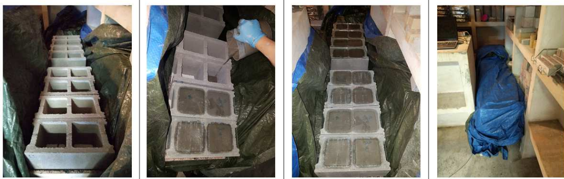
Figura 70. Proceso de llenado de los bloques de hormigón
