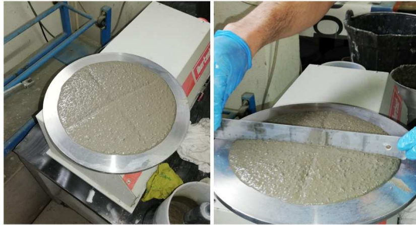
Figura 28. Medición del escurrimiento en el ensayo de la mesa de sacudidas
