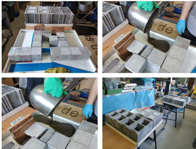
Figura 71. Proceso de refrentado de la primera cara de los bloques
