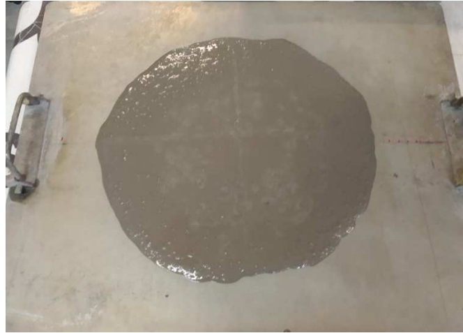
Figura 29. Grout extendido tras ensayo de minislump
