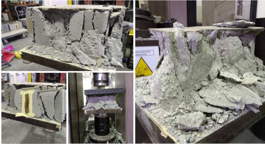
Figura 74. Bloques rellenos ensayados a compresión
