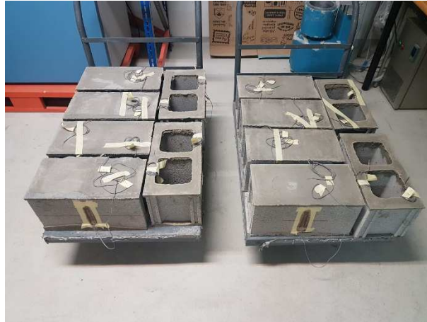
Figura 72. Bloques refrentados y con las galgas ya colocadas
