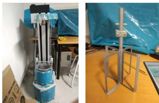
Figura 31. Reómetro Viskomat XL con la pala tipo Window
