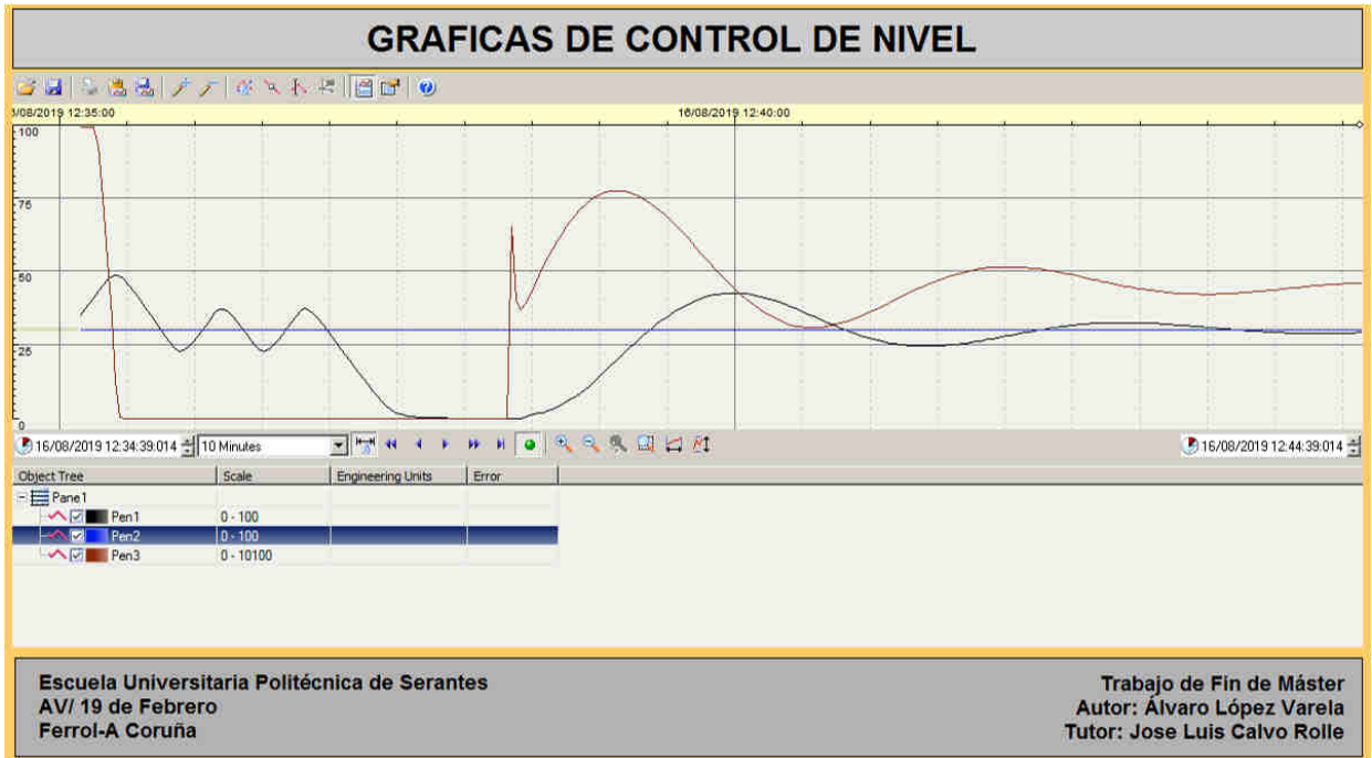
Figura 8.3.1.2 – Respuesta a consigna de 30 con parámetros calculados mediante el método Relay-Feedback con constantes estándar
