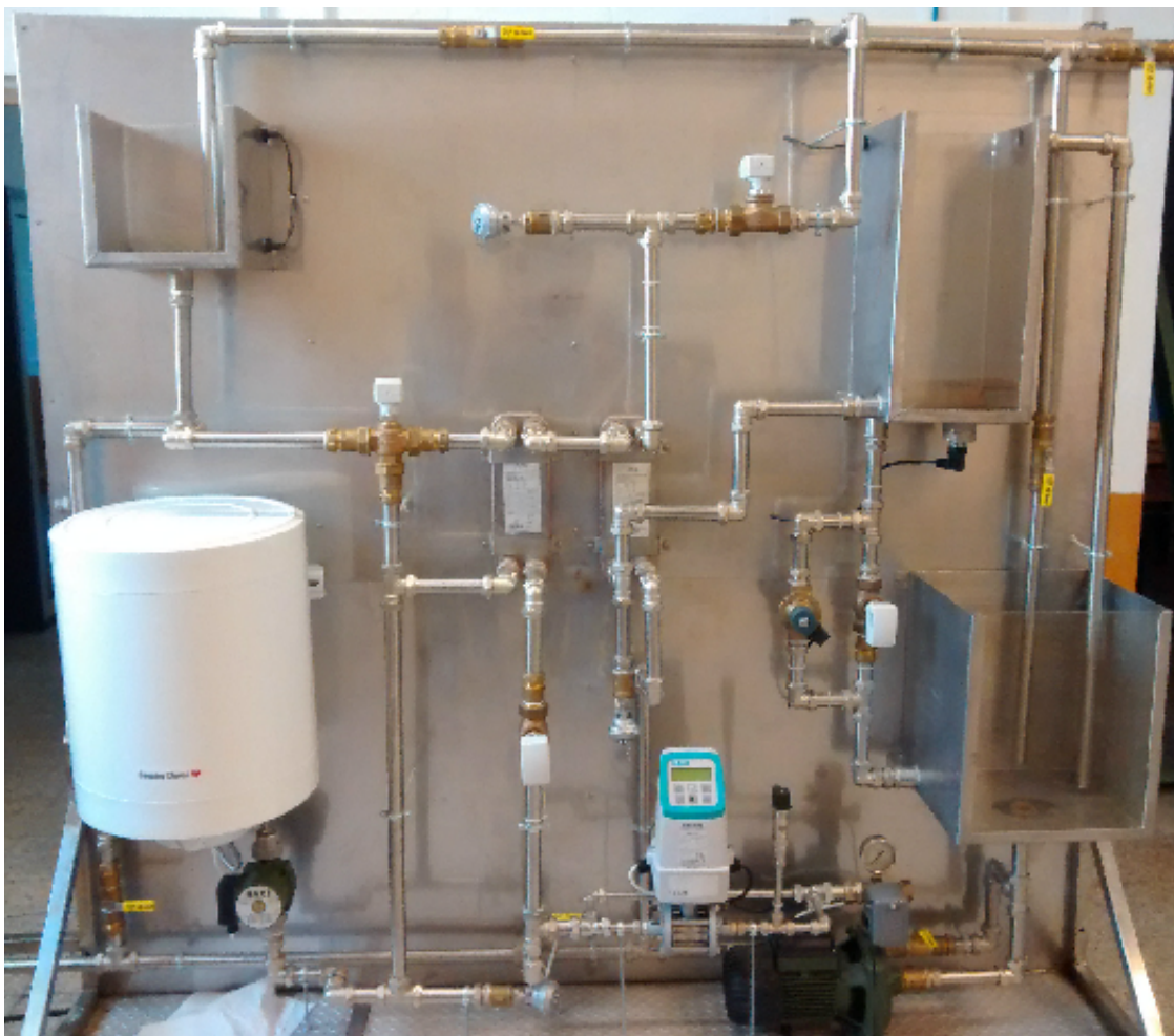
Figura 3.1.0.1 – Planta de laboratorio de controles varios
