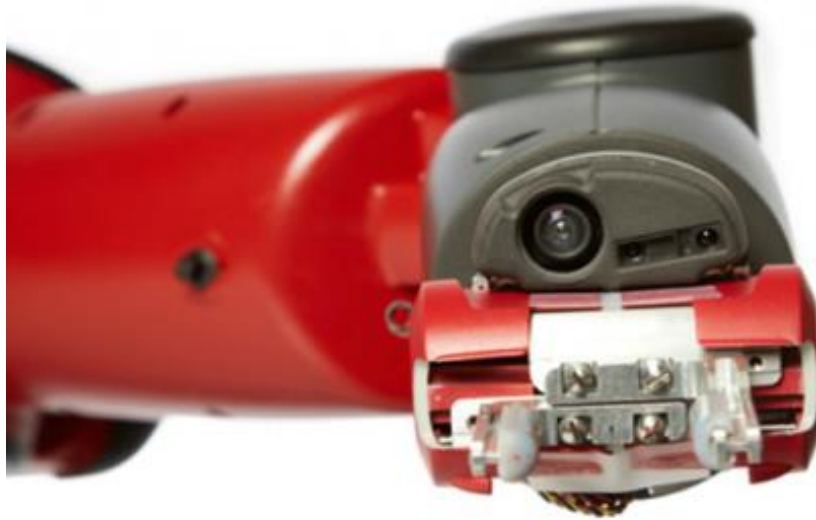
Figura 5-6. Sensores de la parte inferior de la muñeca del robot.
