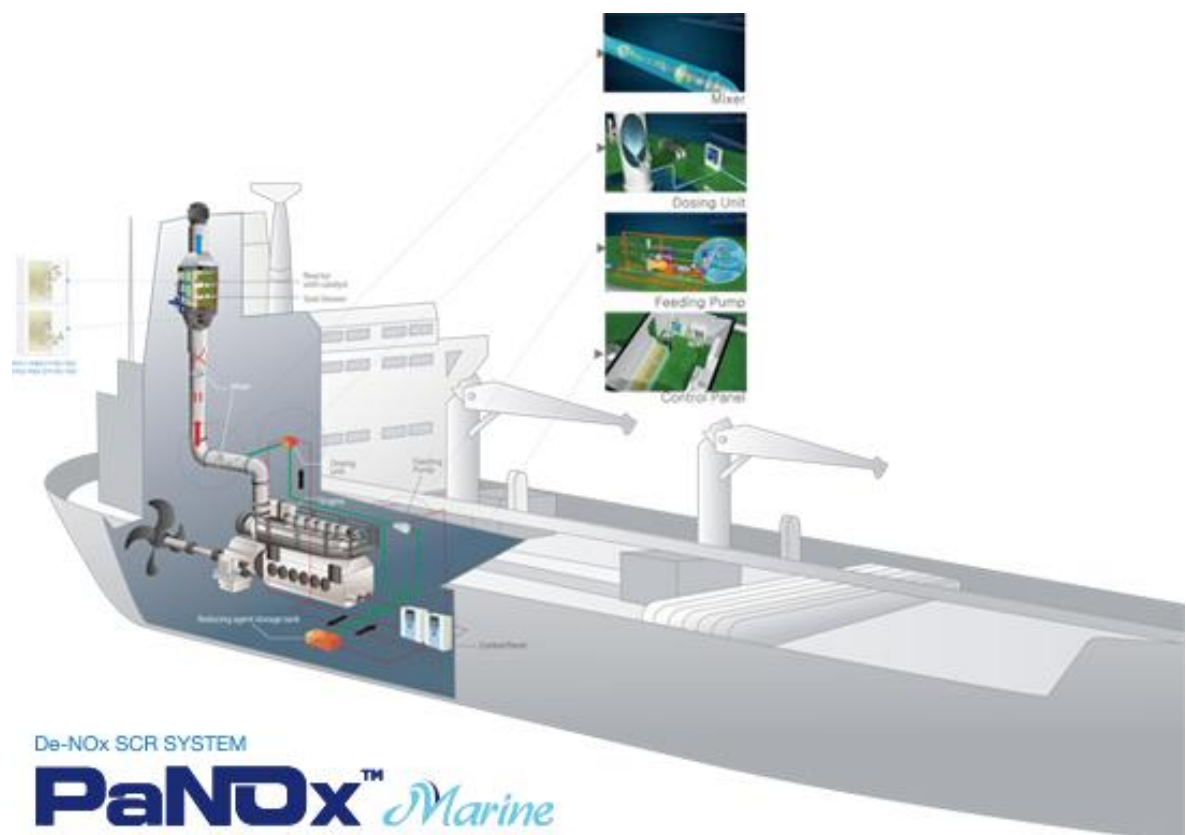
Figura 5.8.1 - Reducción catalítica selectiva (SCR) para la reducción de NOx Fuente: Worldpanasia [39]
