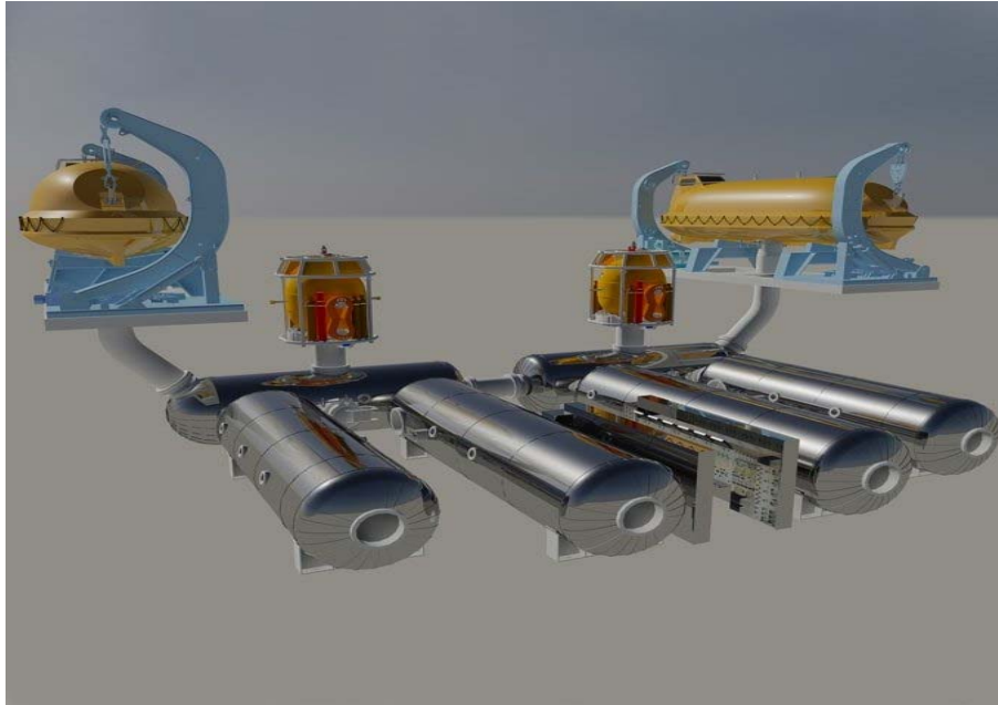
Figura 3.3.6. Complejo hiperbárico de saturación en el que se observan las dos unidades de rescate hiperbárico (HES). Fuente: Unique Group. https://www.uniquegroup.com
