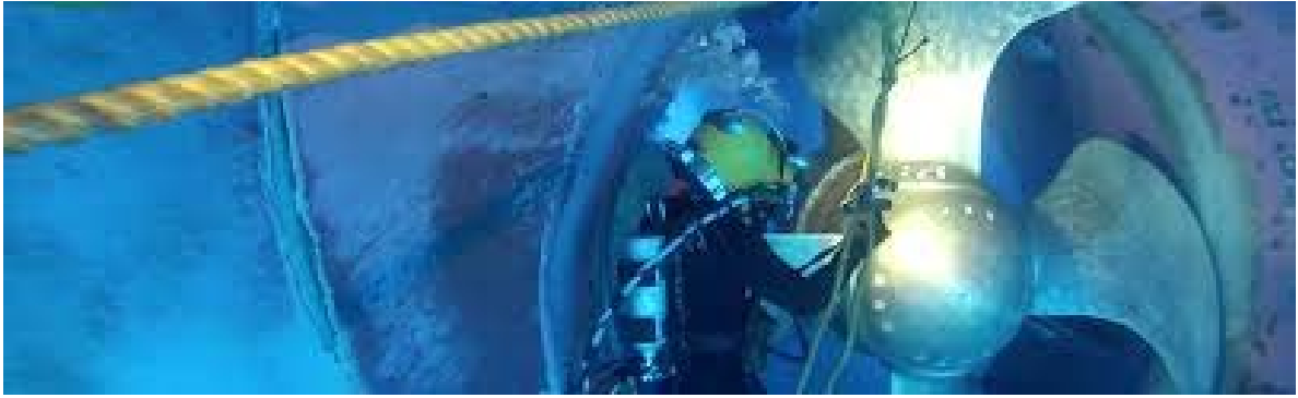
Figura 3.3.5. Buceador trabajando en una hélice de maniobra. Fuente: Seatechdiving. Commercial Diving Services Ltd. http://www.seatechdiving.co.uk/
