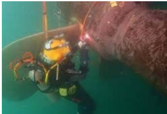
Figura 2.3.2. Buceador trabajando en la hélice de un buque. Fuente: Careers New Zealand.
