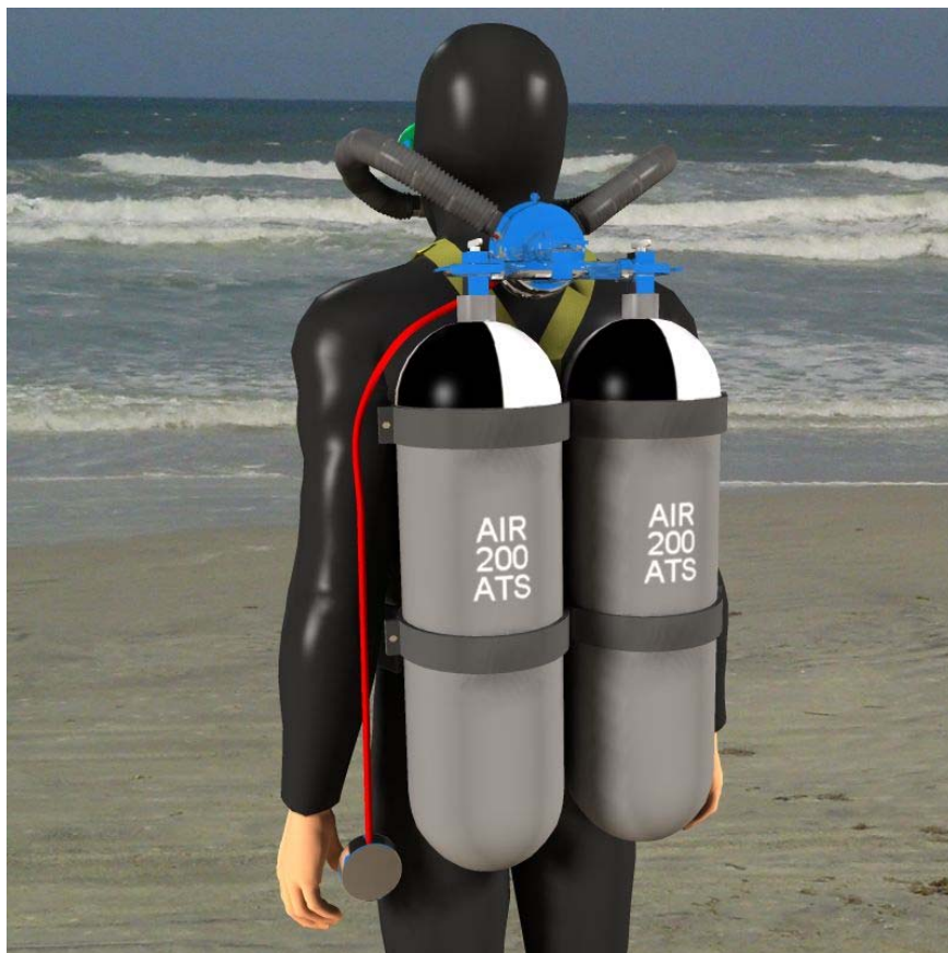
Figura 1.1.9. Equipo de buceo autónomo a demanda “Aqua-lung”, diseñado por Émile Gagnán y probado por Jaques Cousteau (1943). Fuente: https://en.wikipedia.org/wiki/Aqua-Lung
