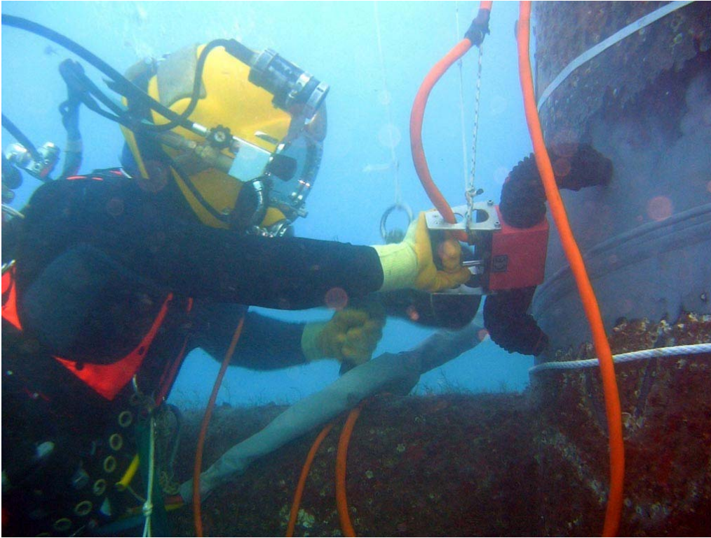
Figura 2.3.3. Buceador realizando una inspección con ensayos no destructivos (NDT). Fuente: Impresub Diving and Marine Contractor. http://www.impresub.com/en/services/ndt-inspection.html
