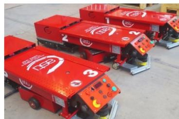
Figura 1: Modelo de AGV empleado
