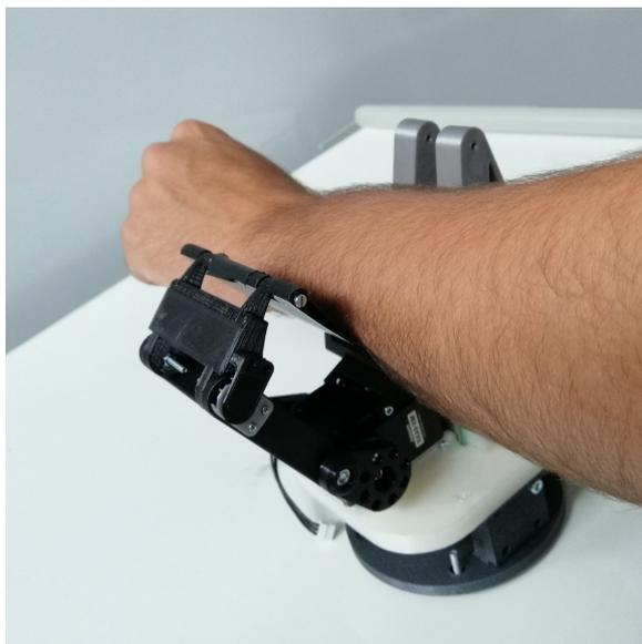
Figura 7: Fotografía de la pinza con un brazo posicionado en el lugar de agarre.
