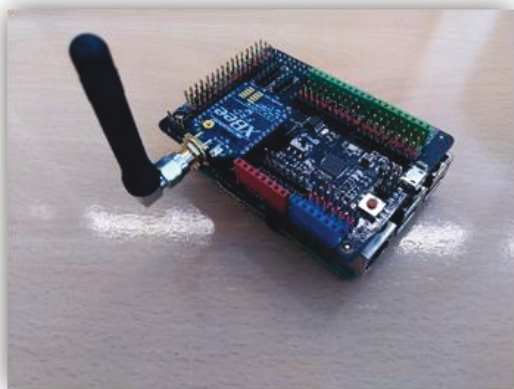
Figura 1: Nodo del sistema fuera del encapsulado.
