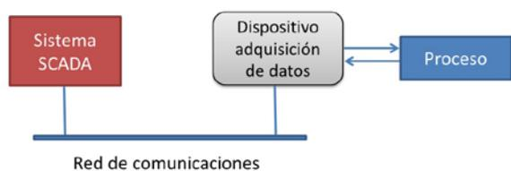
Figura 1: Diagrama de bloques general de sistema de supervisión aplicado a proceso
