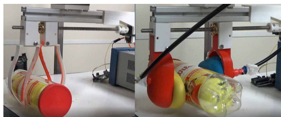
Figura 9: Ambas pinzas cogiendo las pelotas de tenis
