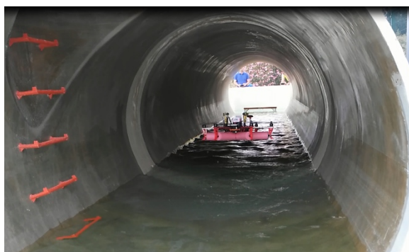
Figura 10: Pruebas sobre lámina de 40 cm de agua, con ajuste en altura de 30cm sobre la misma
