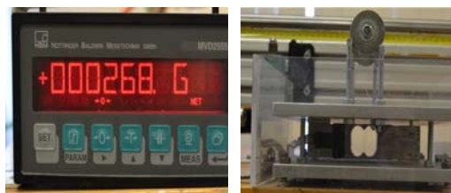
Figura 11: Acondicionador y célula de carga
