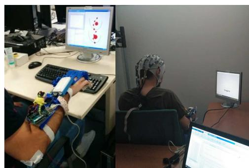
Figura 10: Usuarios realizando una prueba con la estrategia de control EMG (izquierda) y con la estrategia de control BCI (derecha)
