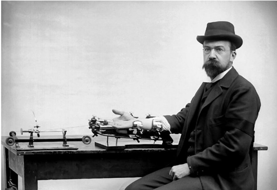
Figura 1.1: Angelo Mosso posa en su ergógrafo. Falta el tubo ahumado de registro.
