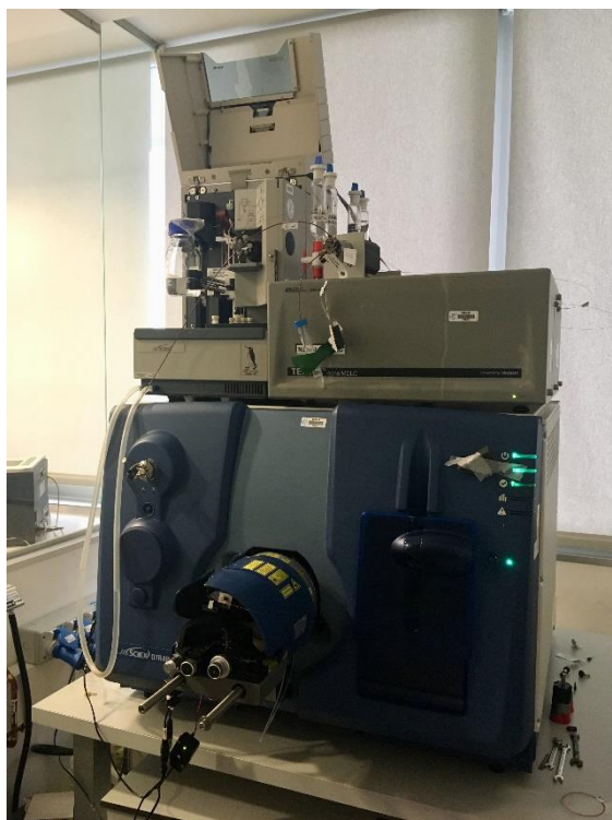
Figura 7. Sistema cromatográfico nano LC (Sciex) acoplado a un espectrómetro de masas 5500 QTRAP (Sciex).
