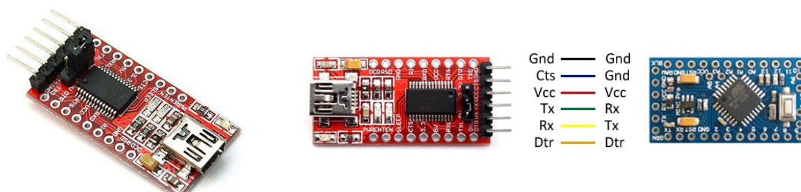
Figura 25: Comenzando por la izquierda a) módulo FTDI y b) conexionado con el Arduino.
