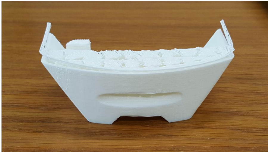
Figura 66: Problema en la impresión de la pieza Maxilar.
