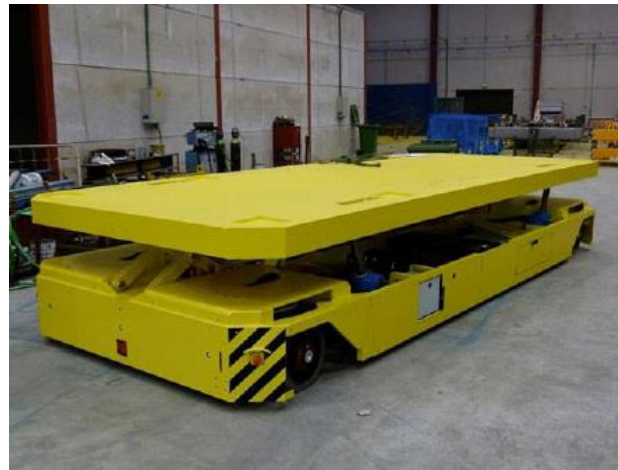
Figura 6 Ejemplo de carretón y AGV para el transporte de piezas (Fuente: www.dta.es )
