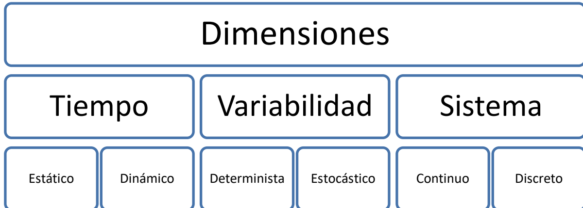
Figura 2 Clasificación de los modelos de simulación (Elaboración propia)
