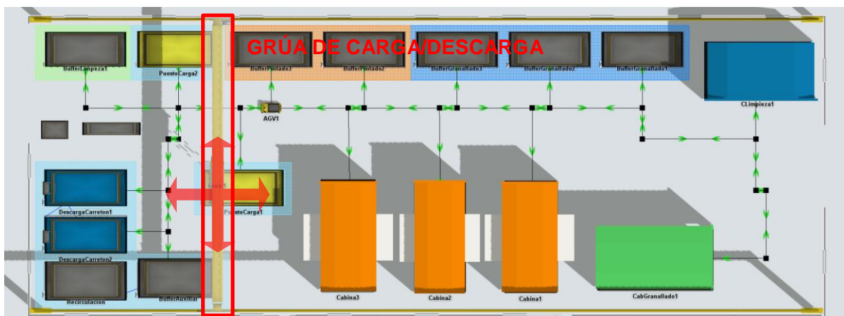
Figura 18 Carga y descarga de piezas en Layout 2
