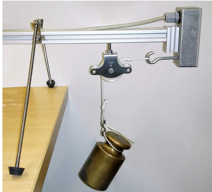
Figura 26. Calibración interfaz de amplificación célula de carga
