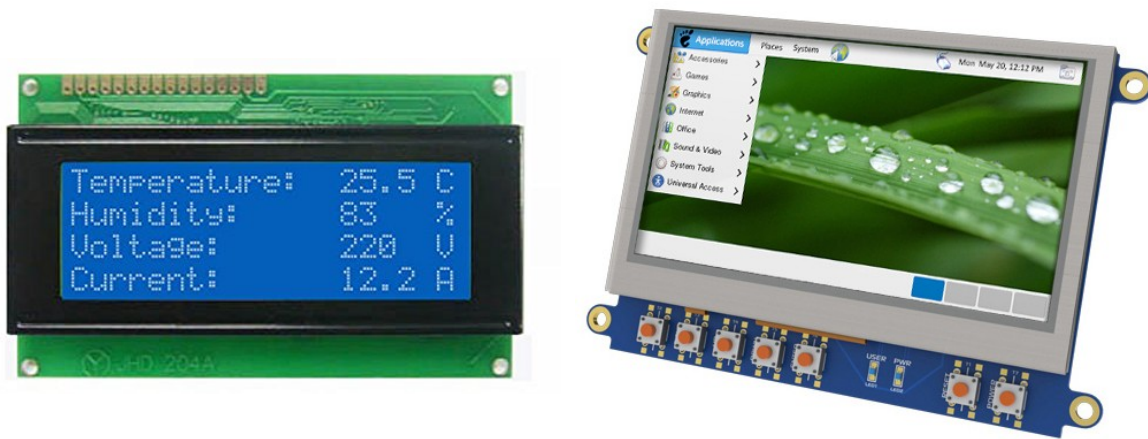
Figura 7. Pantalla LCD (izquierda) vs TFT (derecha)
