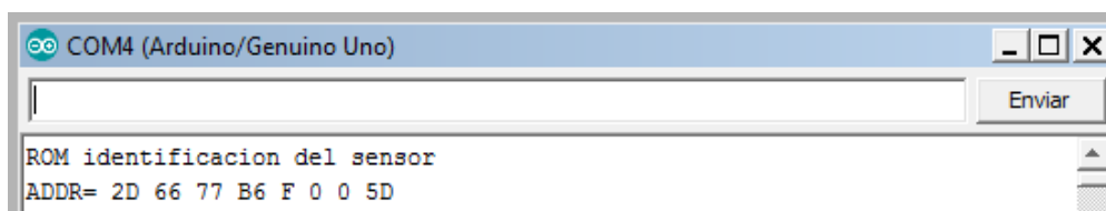
Figura 3.3.4.6.3: Monitor serie Arduino. Código ROM EEPROM sensor PT1000
