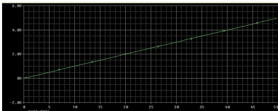
Figura 3.3.4.4.9: Simulación en OrCAD de la Salida de la etapa de amplificación / Entrada de señal al Arduino
