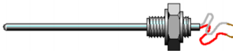
Figura 3.3.4.1.2: Vaina típica de un sensor RTD industrial
