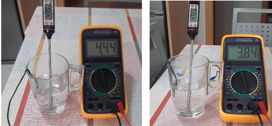
Figura 3.3.6.3.1: Calibración de la NTC mediante un termómetro
