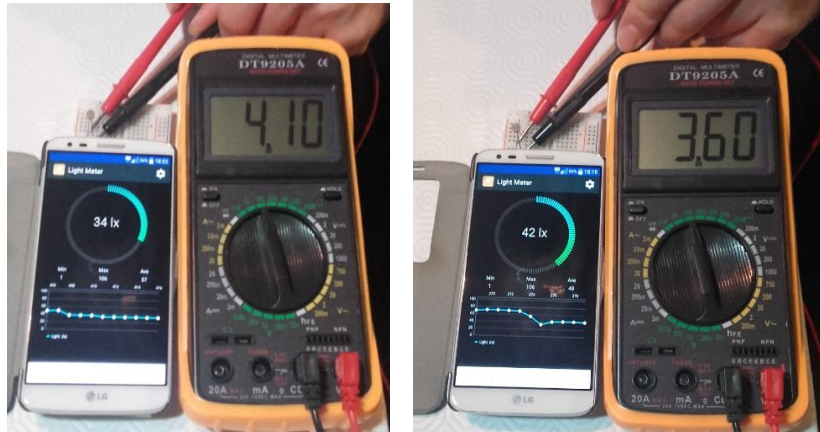
Figura 3.3.5.3.1: Calibración de la LDR mediante el luxómetro del teléfono móvil
