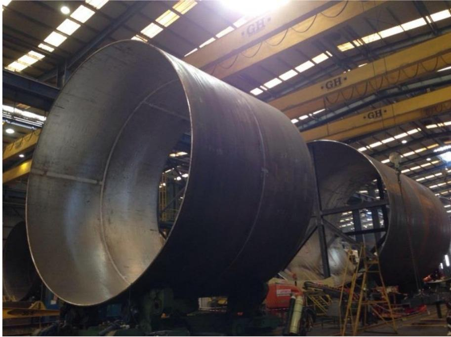
**Figura 20: Ensamblaje de dos partes de un pilote**
