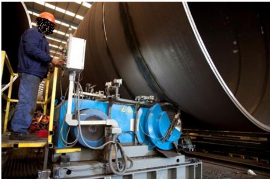
**Figura 22: Máquina fija para soldadura circular externa**
