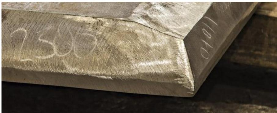
Figura 15: Biselado de una chapa lista para soldar
