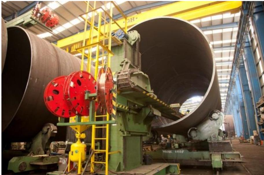
**Figura 21: Máquina para soldadura circular interna**
