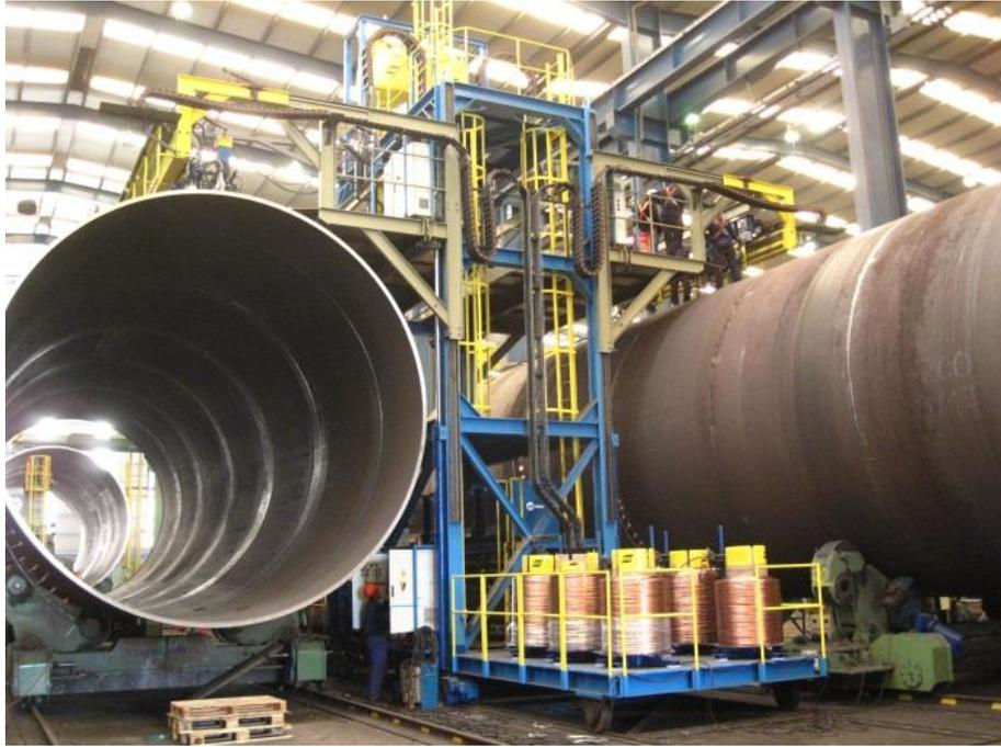
**Figura 23: Máquina para las soldaduras circulares externas**
