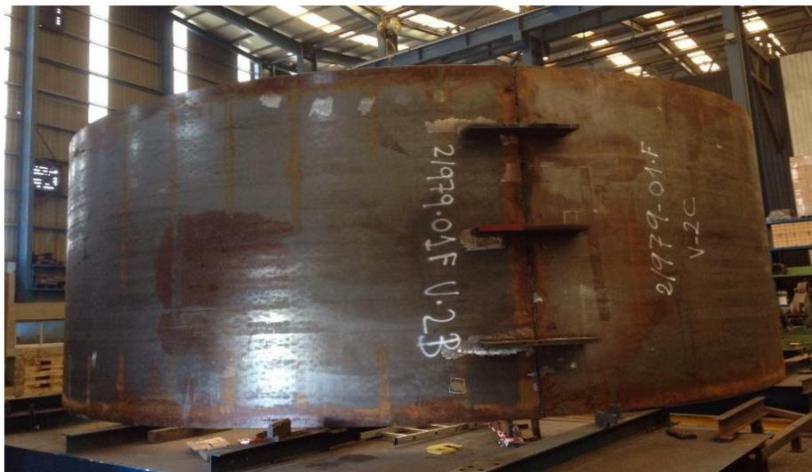
Figura 19: Soldadura longitudinal de una parte de un pilote
