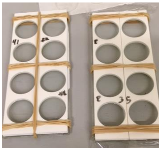
Figura 17. Montaje de los moldes de las siliconas
