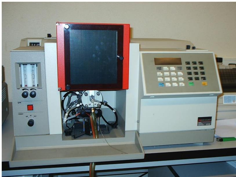
Figura 63. Espectrofotómetro de absorción atómica
