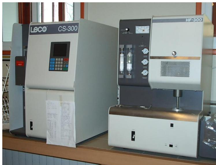
Figura 62. Analizador LECO CS-300 de azufre y carbono
