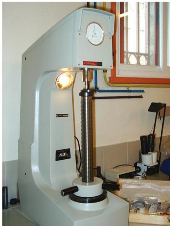
Figura 66. Durómetro
