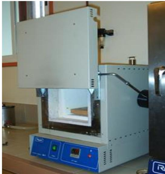
Figura 64. Horno marca Raypa modelo HM-9 empleado en los tratamientos térmicos
