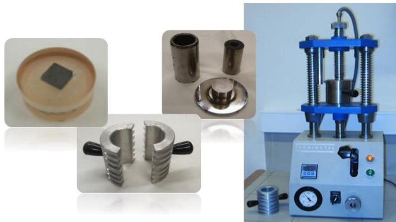
Figura 72. Empastilladora, enfriador, accesorios de moldeo y probeta empastillada
