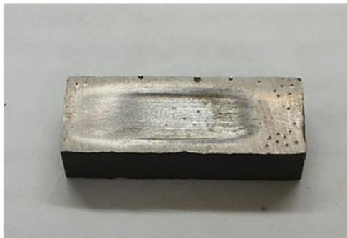
Figura 79. Probeta sometida a un ensayo de rueda de caucho y arena húmeda
