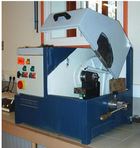
Figura 71. Cortadora metalográfica
