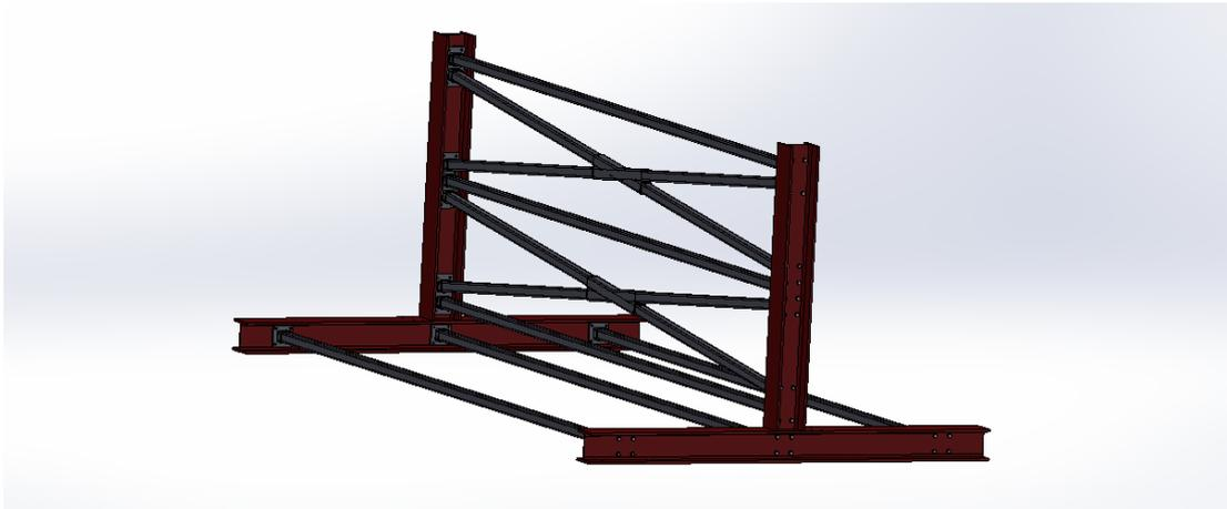
**Ilustración 16: Unión de las bases mediante largueros (Vista 2)**
