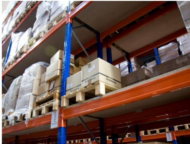
**Ilustración 2: Estantería para carga paletizada**
