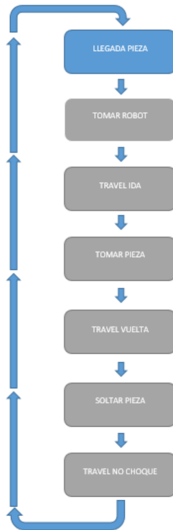
Figura 33. Diagrama de flujo general de la función del brazo robótico (Elaboración propia).
