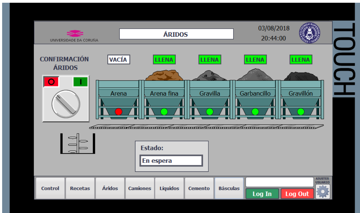
Figura 15- Pantalla de áridos, se muestra estado de las tolvas y del proceso.
