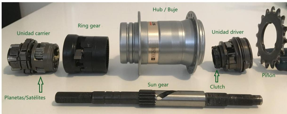
**Figura 2.3** Partes principales del sistema
