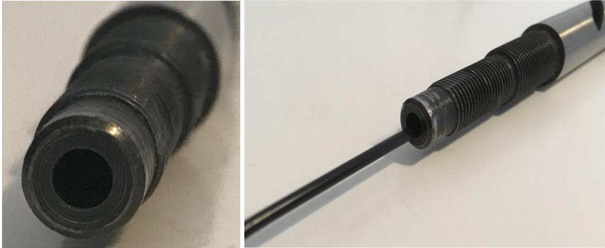
**Figura 2.6** Detalle de eje con sección hueca (izquierda). Eje con empujador metálico para realizar el cambio de marcha (derecha)
