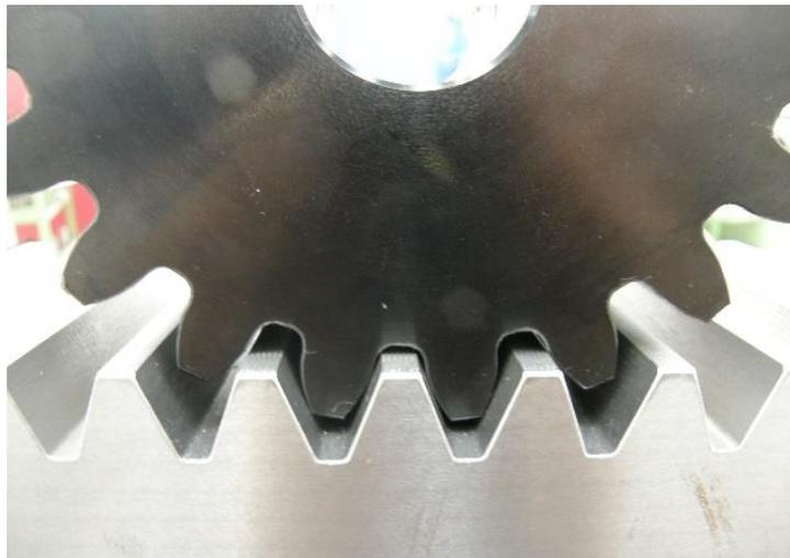
**Figura 3.3** Cremallera de generación de perfiles de evolvente
