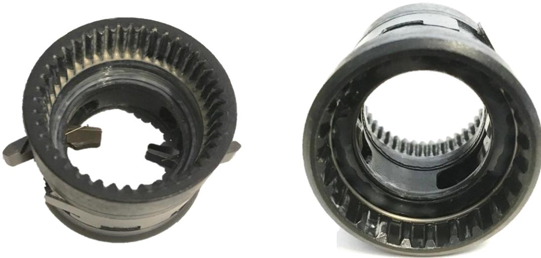
**Figura 2.8** Unidad ring con detalles de trinquetes (izquierda) y muescas (derecha)
