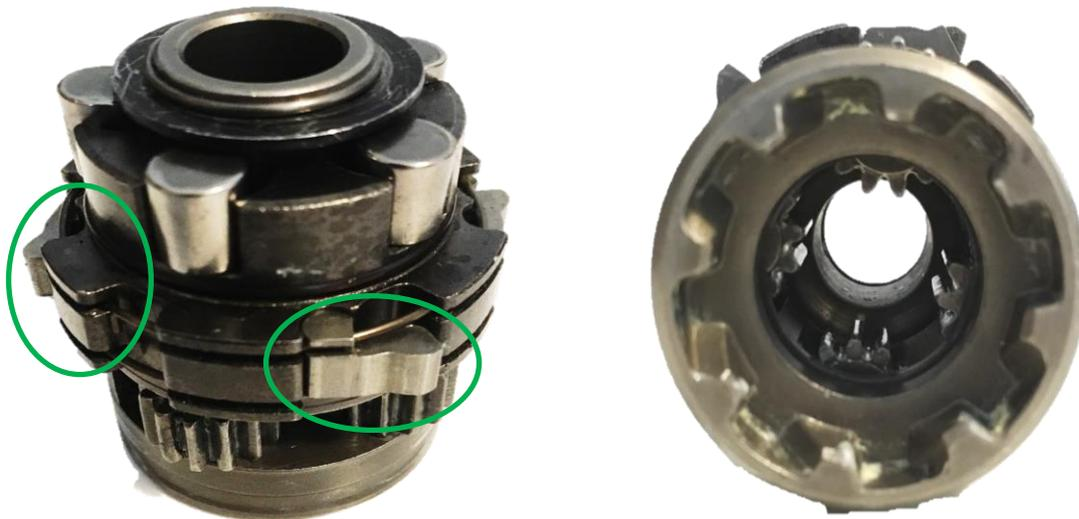
**Figura 2.9** Unidad carrier con detalles de trinquetes (izquierda) y muescas (derecha)
