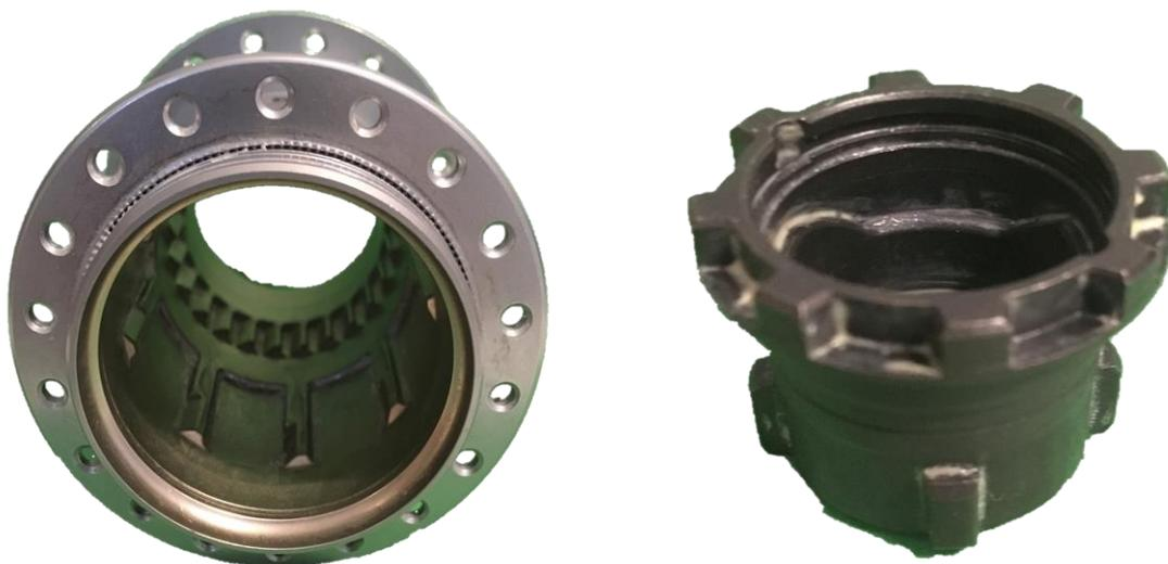
**Figura 2.10** Muescas en el interior del buje (izquierda). Las más cercanas corresponden a los trinquetes del ring, mientras que las más alejadas corresponden a los del carrier. A la derecha, muescas en clutch
