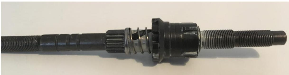
**Figura 2.5** Detalle de clutch con resortes montado sobre eje
