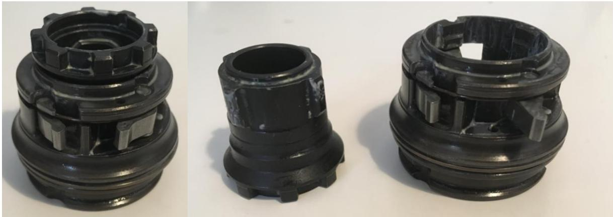
**Figura 2.4** Detalle de unidad driver ensamblada, con despiece de clutch y cuerpo de unidad driver (derecha)
