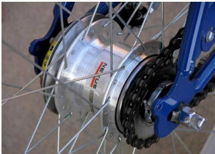
**Figura 2.1** Sistema de cambio integrado en buje montado en eje trasero de la bicicleta
