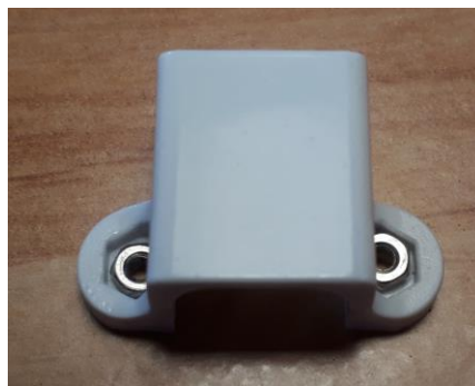
Figura 99 Soporte con las tuercas en las abrazaderas
