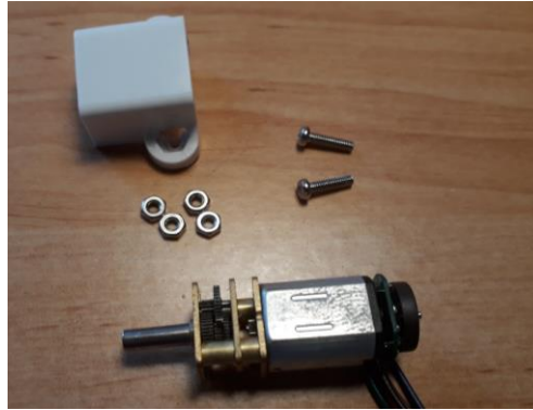
Figura 98 Componentes necesarios para colocar el motor en su lugar
