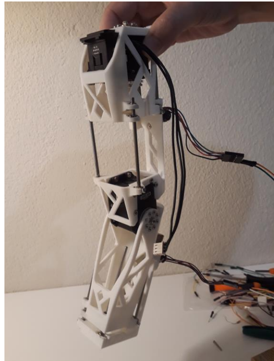
Figura 120 Extremidad superior con el brazo extendido y el antebrazo contraído (2)
