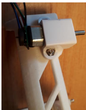
Figura 17 Motor colocado en la pieza inferior del brazo
