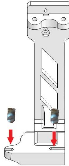
Figura 93 Posición de las sujeciones en la pieza inferior de del antebrazo
