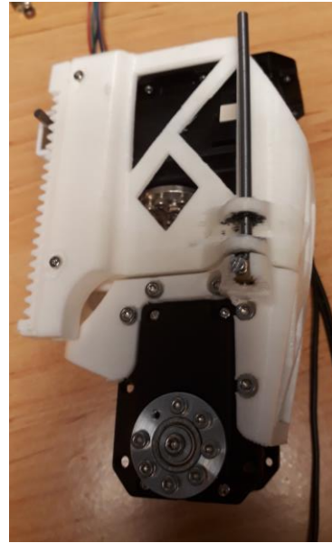
Figura 110 Brazo con las varillas ya colocadas
