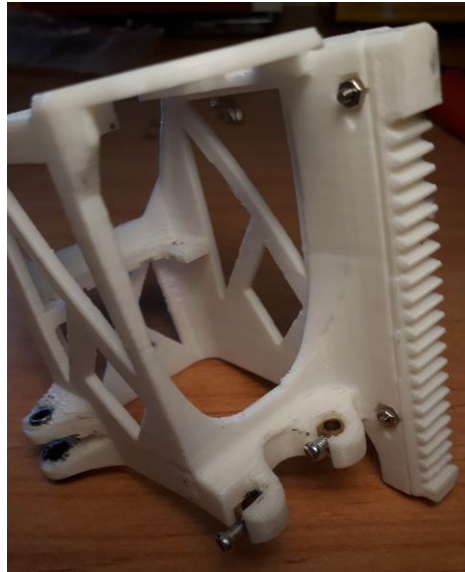
Figura 104 Cremallera fijada a su posición
