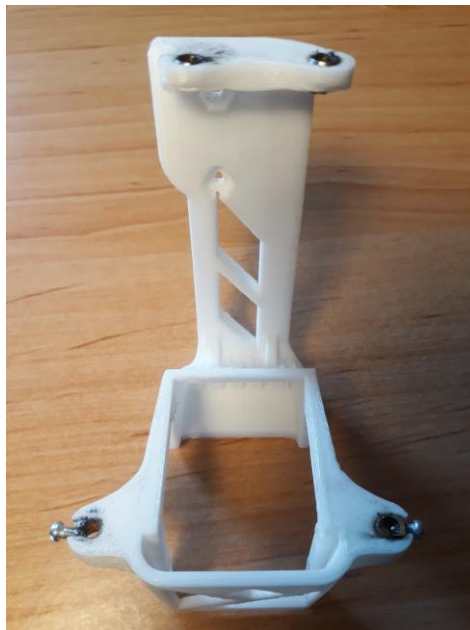
Figura 97 Sujeciones y anillos guía ya colocados en la pieza inferior del brazo
