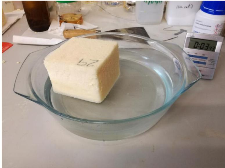
*Figura 25. Ensayo de absorción de agua*
