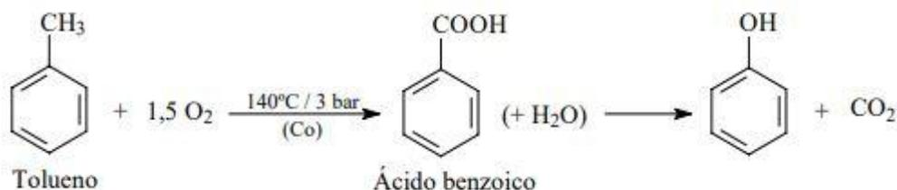
*Figura 5. Ácido benzoico descarboxila con catalizador de cobre dando fenol.
