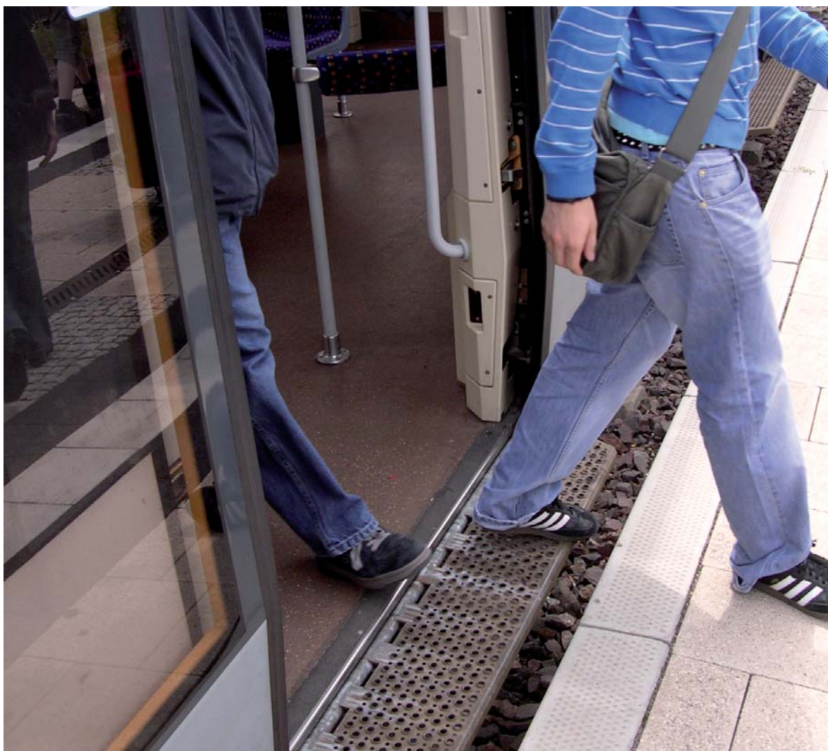
Detalle de plataforma retráctil del tranvitrén de Saarbrücken para facilitar el acceso y salida del vehículo en las estaciones ferroviarias. Autor: Axel Kühn.
