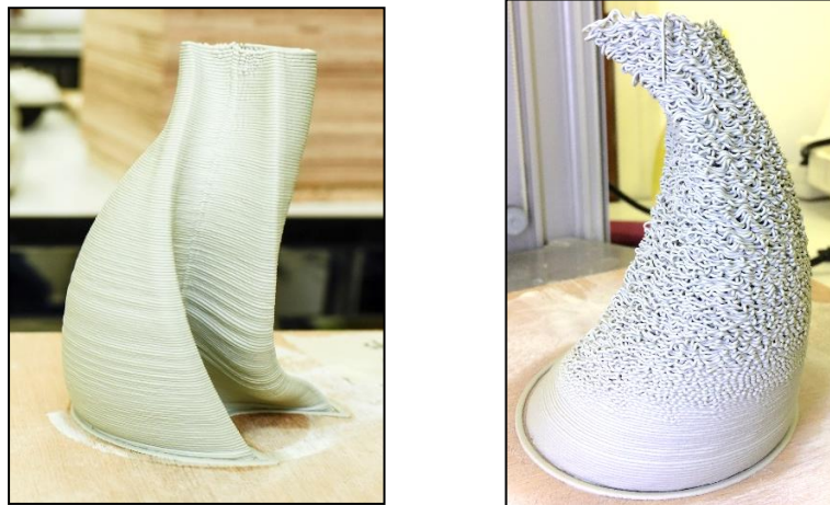
Figura 28 Mestura de Porcelana1, auga e Na 2 SiO 3 impresa con 2 pases (esquerda) e 1 pase (dereita)
