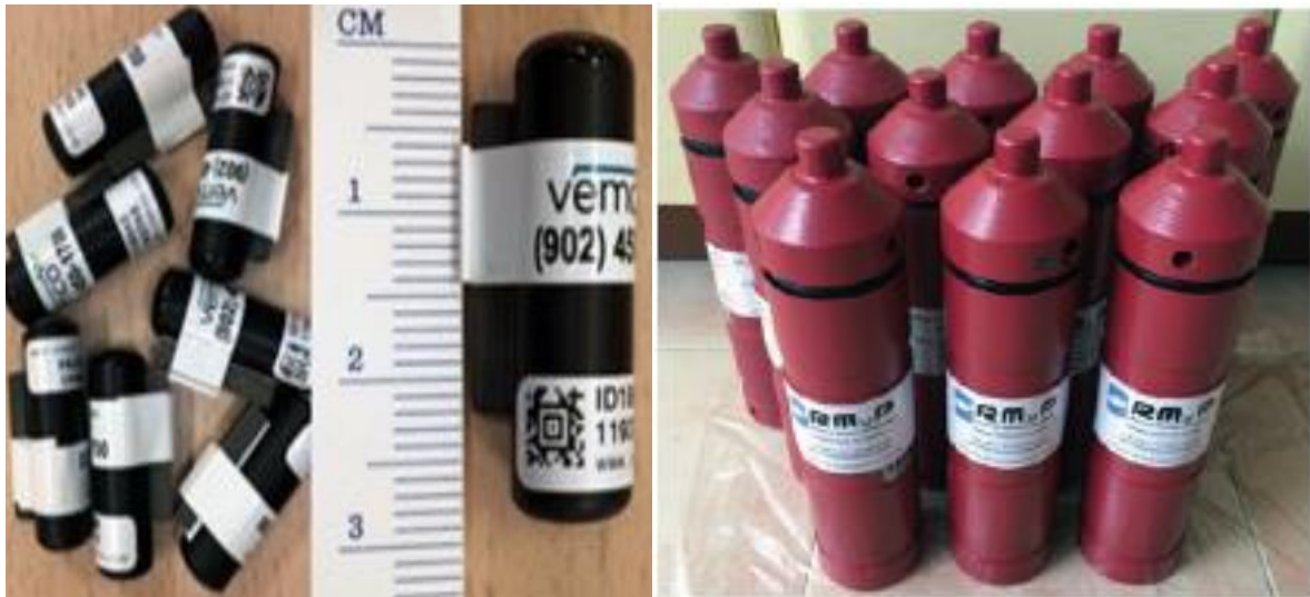
Figura 3: Modelo de transmisor V9 (Vemco Ltd.) y receptores VR2W que se utilizaron durante el seguimiento
