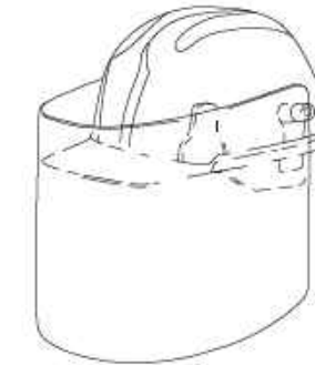
CASCO DE SEGURIDAD con pantalla antiproyecciones
