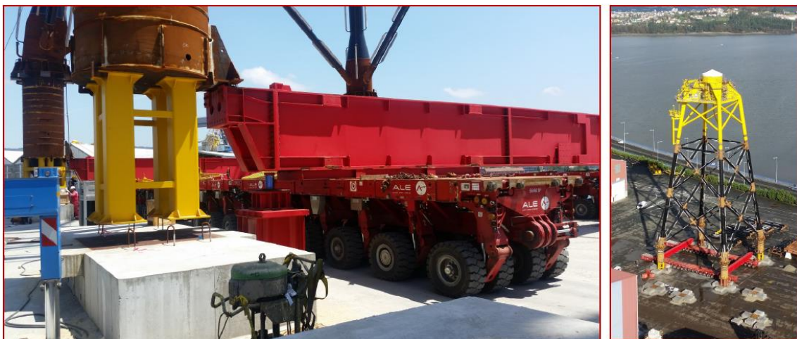
Figura 24. Transportador modular autopropulsado proyecto Wikinger
