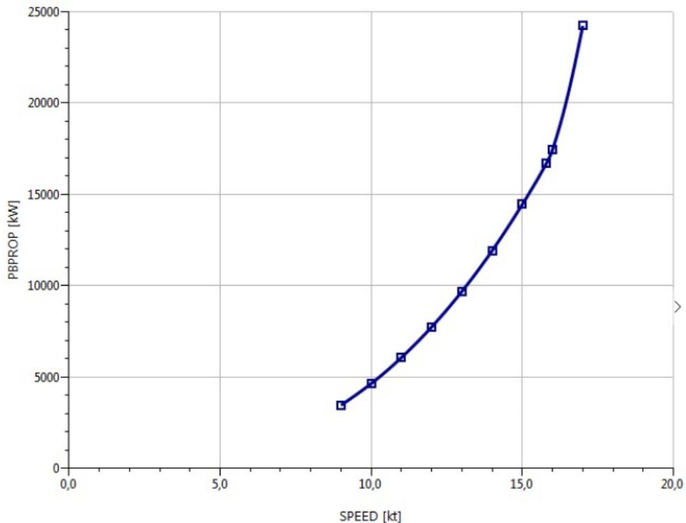
Se obtiene que a una velocidad de 15,8 Kn es necesaria una Potencia efectiva de 16718 KW
