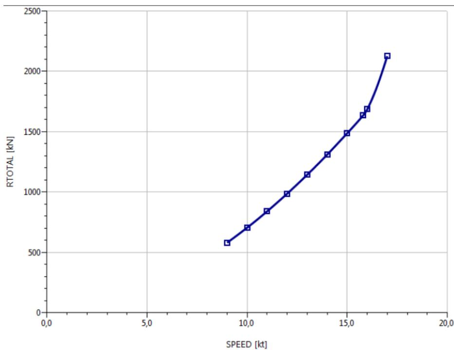
Para una velocidad de 15,8 kn se obtiene una Resistencia al avance de 1637 Kn
